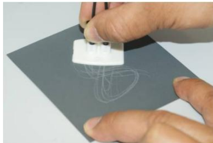
Рисунок 5.5 - Процесс шлифования торца оптоволоконна
