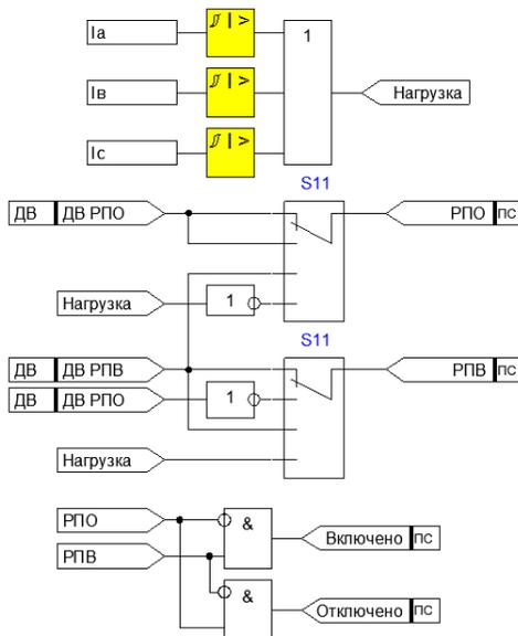
Рисунок 4.3.1 – Функциональная схема определения положения ВВ
