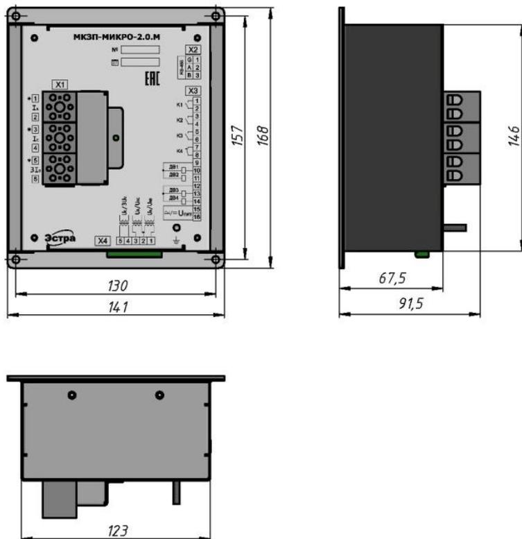
Габаритный чертеж корпуса МКЗП-Микро 2.0 и 2.0Д
