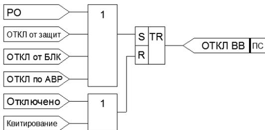
Рисунок 4.3.8 – Функциональная схема формирования сигнала отключения ВВ
