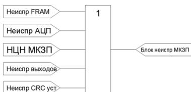
Рисунок 4.15 – Функциональная схема сигналов самодиагностики устройства
