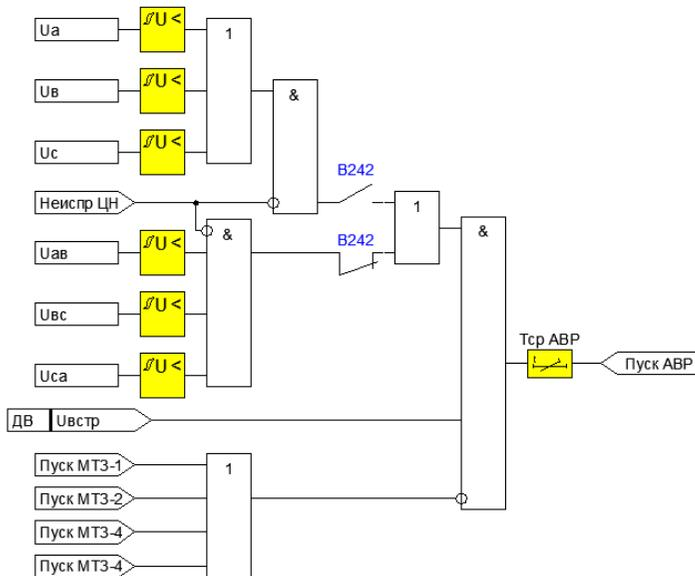
Рисунок 4.2.2 – Функциональная схема формирования сигнала пуска АВР
