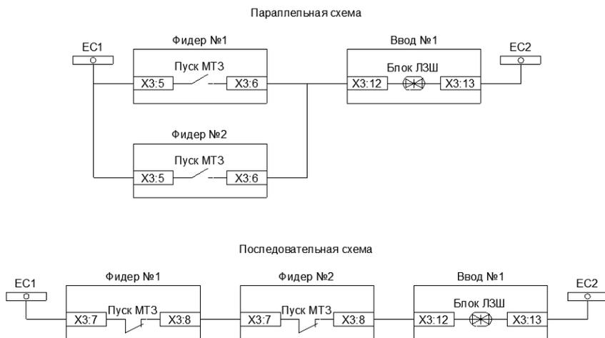
Рисунок 4.1.20 – Параллельная и последовательная схемы ЛЗШ
