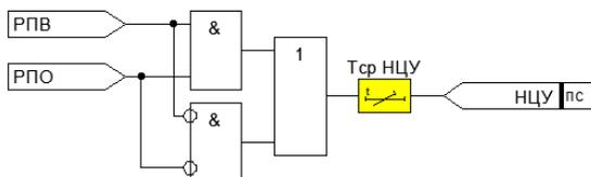
Рисунок 4.4.1 – Функциональная схема формирования сигнала НЦУ
