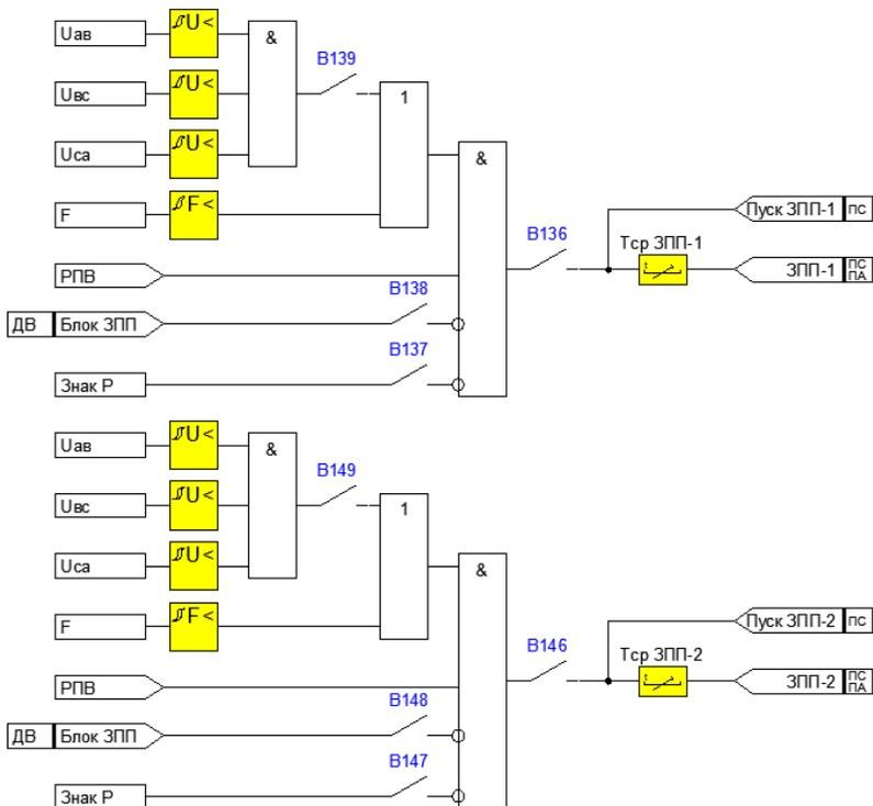
Рисунок 4.1.23 – Функциональная схема ЗПП-1 и ЗПП-2
