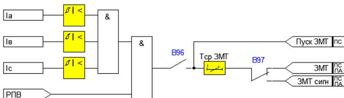
Рисунок 4.1.14 – Функциональная схема ЗМТ
