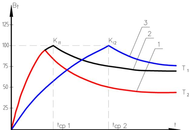
Рисунок 4.1.18 – Зависимости  $B_t = f(t)$  при различных кратностях тока  $K_t$ :
