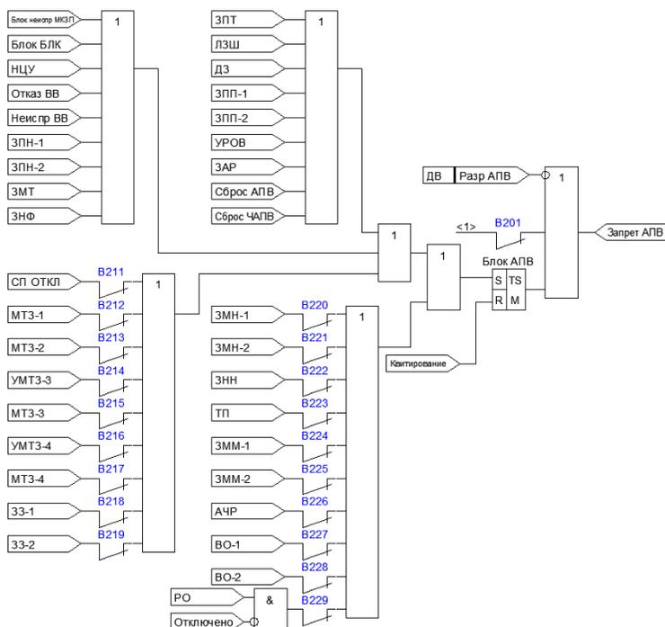
Рисунок 4.2.3 – Функциональная схема формирования сигнала запрета АПВ
