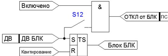
Рисунок 4.3.6 – Функциональная схема внешней блокировки ВВ
