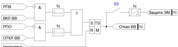
Рисунок 4.4.2 – Функциональная схема формирования сигнала отказа ВВ
