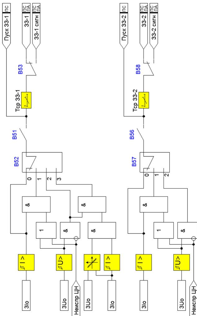
Рисунок 4.1.6 - Функциональная схема 33-1 и 33-2
