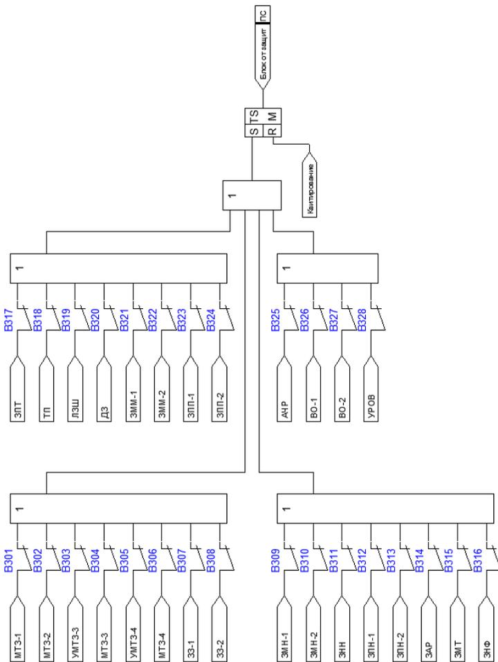
Рисунок 4.3.7 – Функциональная схема формирования сигнала блокировки от защит
