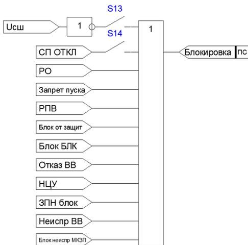
Рисунок 4.3.10 – Функциональная схема формирования сигнала блокировки РВ
