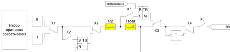
Рисунок 4.6 – Функциональная схема логики свободно программируемого реле
