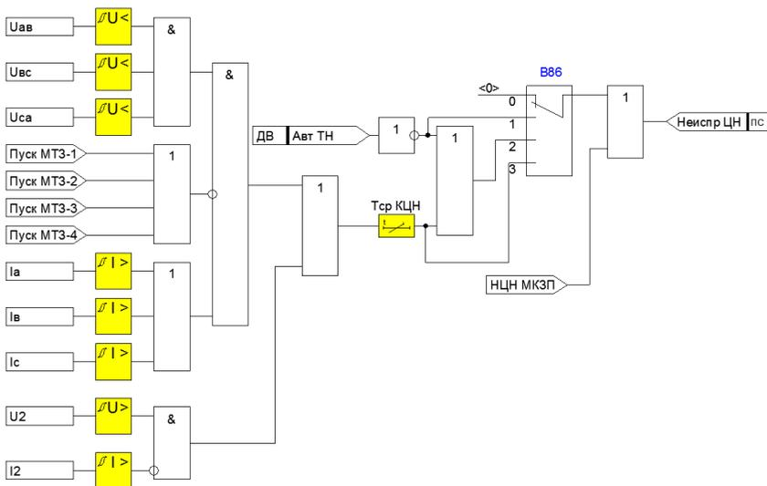
Рисунок 4.1.11 – Функциональная схема контроля ЦН
