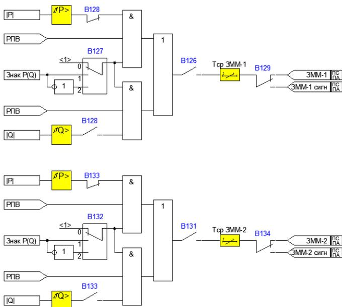
Рисунок 4.1.22 – Функциональная схема ЗММ-1 и ЗММ-2
