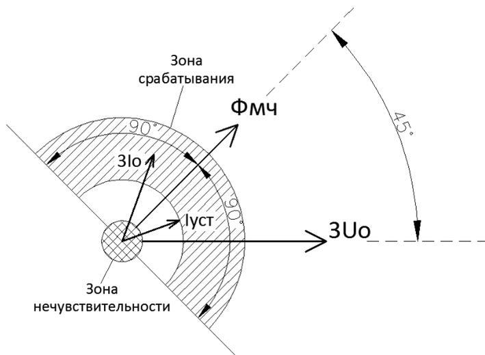
Рисунок 4.1.7 - Определение направления мощности нулевой последовательности
