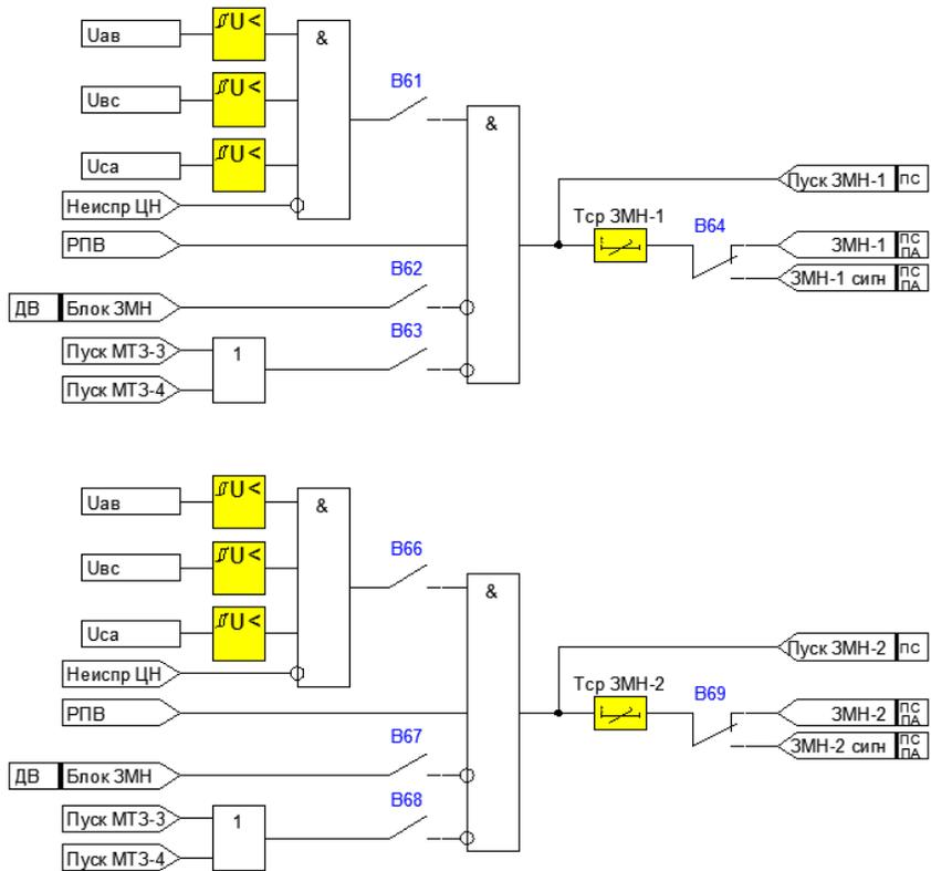
Рисунок 4.1.8 - Функциональная схема ЗМН-1 и ЗМН-2
