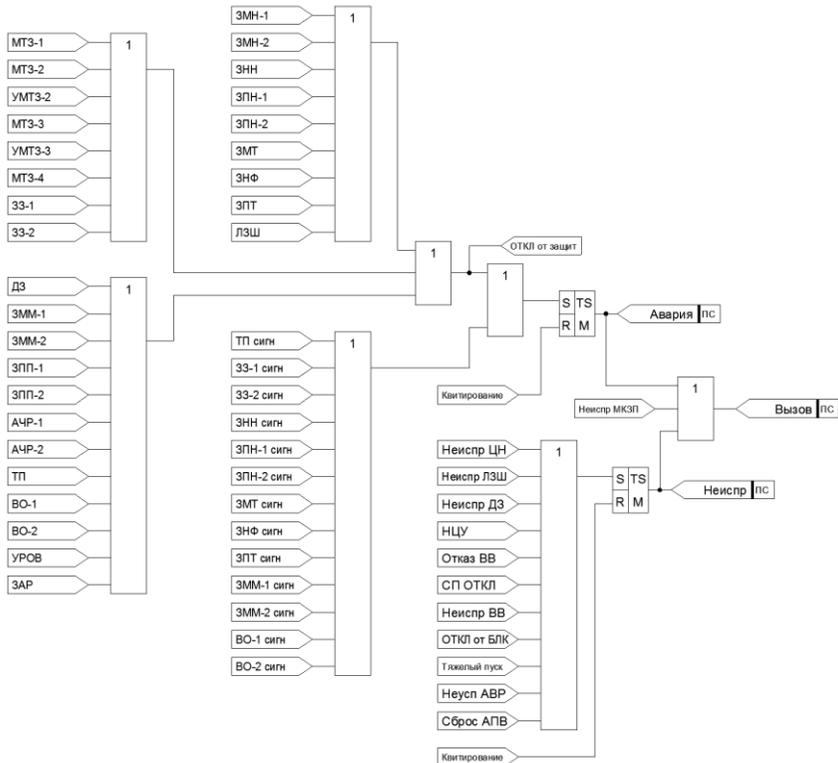
Рисунок 4.5 – Функциональная схема формирования сигналов сигнализации
