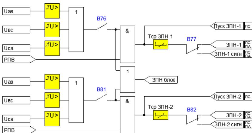
Рисунок 4.1.10 - Функциональная схема ЗПН-1 и ЗПН-2
