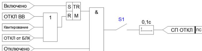
Рисунок 4.4.3 – Функциональная схема формирования сигнала отказа ВВ
