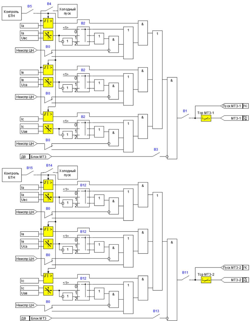
Рисунок 4.1.1 - Функциональная схема МТЗ-1 и МТЗ-2
