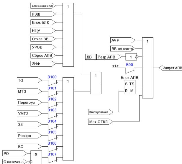
Рисунок 4.2.1 – Функциональная схема формирования сигнала запрета АПВ
