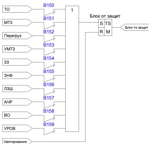
Рисунок 4.3.5 – Функциональная схема формирования сигнала блокировки от защит
