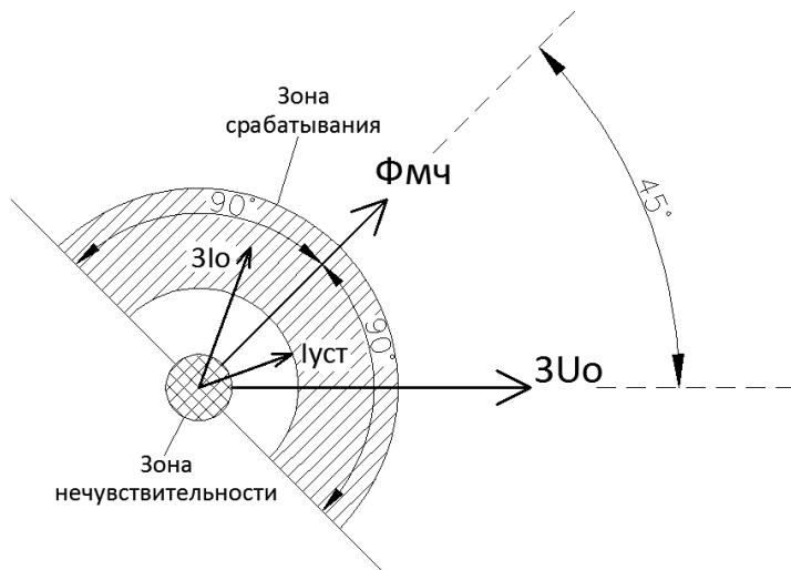
Рисунок 4.1.4 - Определение направления мощности нулевой последовательности
