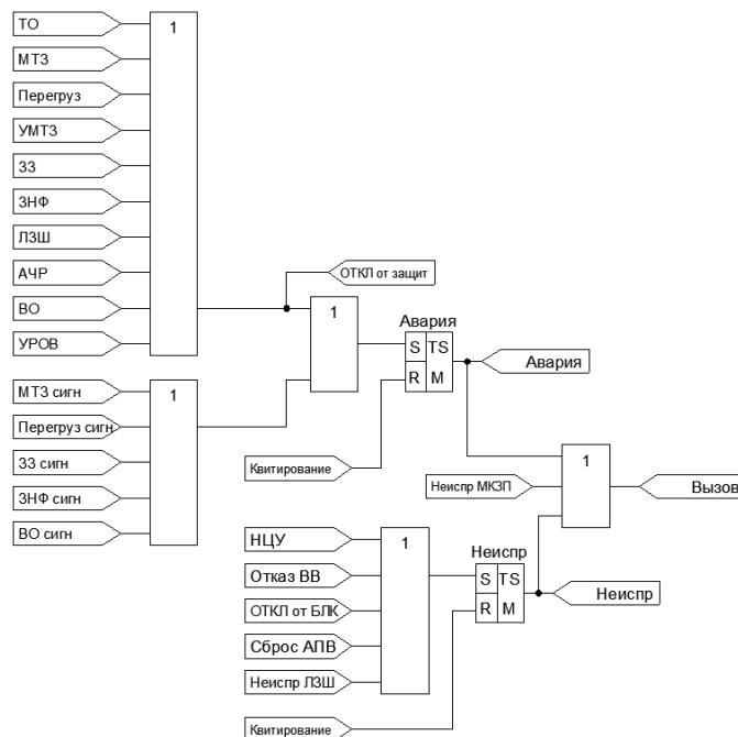
Рисунок 4.5 – Функциональная схема формирования сигналов сигнализации
