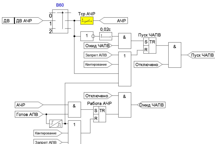
Рисунок 4.2.3 – Функциональная схема АЧР по одному ДВ
