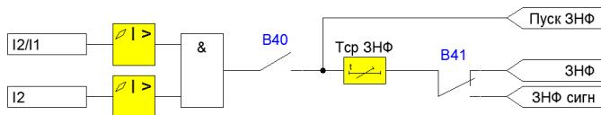
Рисунок 4.1.5 – Функциональная схема ЗНФ
