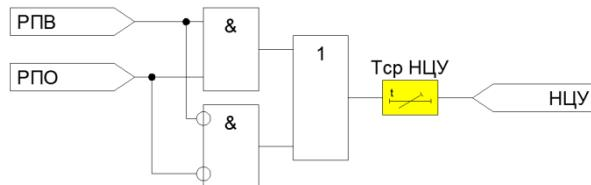
Рисунок 4.4.1 – Функциональная схема формирования сигнала НЦУ
