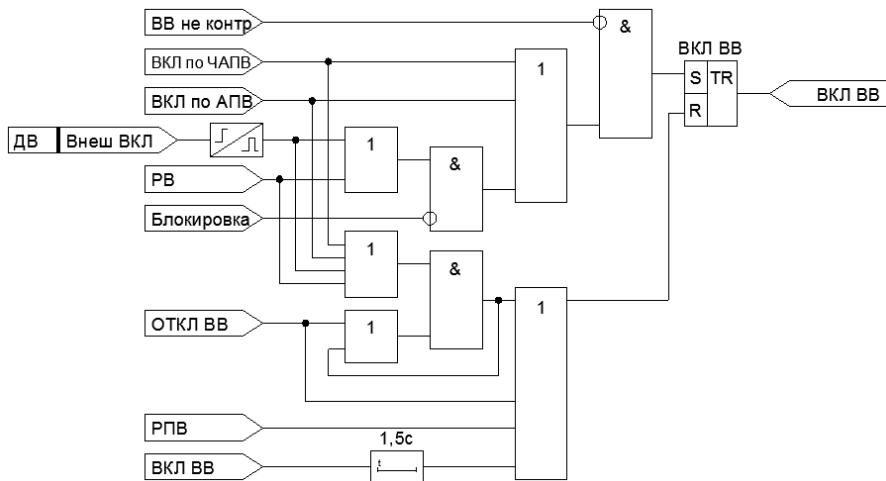
Рисунок 4.3.7 – Функциональная схема формирования сигнала включения ВВ
