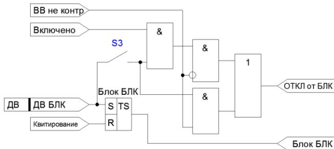
Рисунок 4.3.4 – Функциональная схема внешней блокировки ВВ
