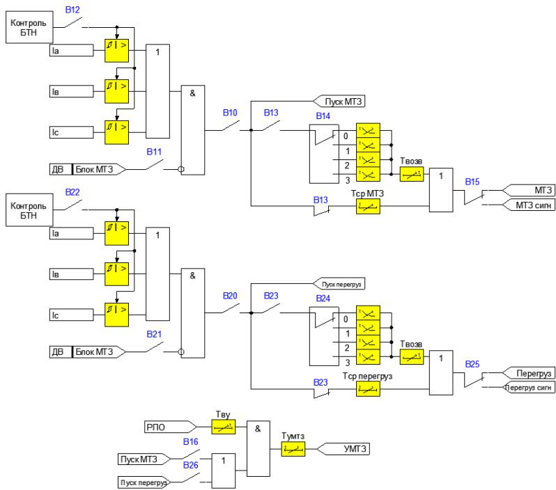
Рисунок 4.1.2 - Функциональная схема МТЗ и перегрузки
