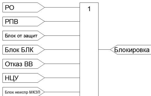
Рисунок 4.3.8 – Функциональная схема формирования сигнала блокировки РВ
