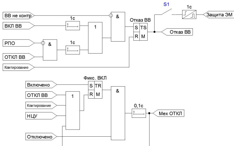
Рисунок 4.4.2 – Функциональная схема формирования сигнала отказа ВВ
