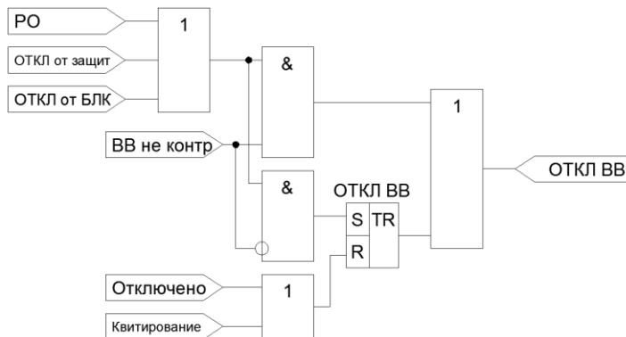
Рисунок 4.3.6 – Функциональная схема формирования сигнала отключения ВВ
