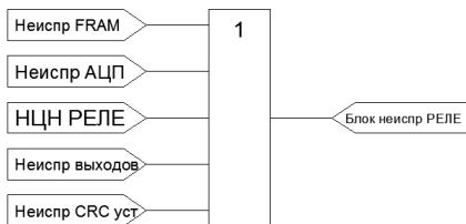
Рисунок 4.10 – Функциональная схема сигналов самодиагностики устройства
