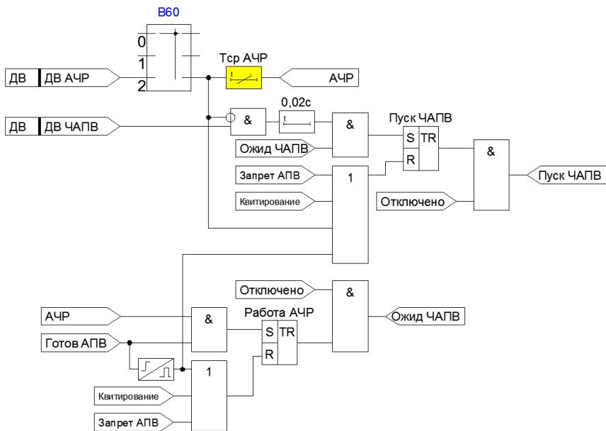
Рисунок 4.2.4 – Функциональная схема АЧР по двум ДВ
