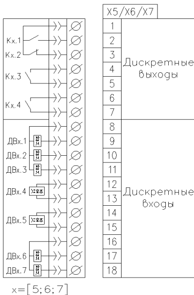
Рисунок 3.1 – Конфигурация разъемов дополнительных дискретных входов и выходов
