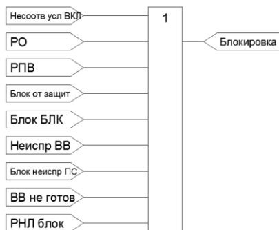
Рисунок 3.3.10 – Функциональная схема формирования сигнала блокировки РВ
