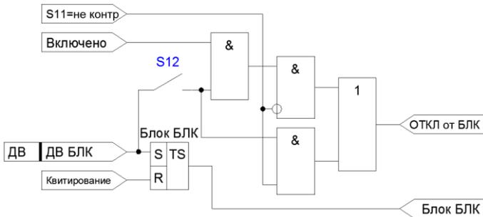
Рисунок 4.3.6 – Функциональная схема внешней блокировки ВВ
