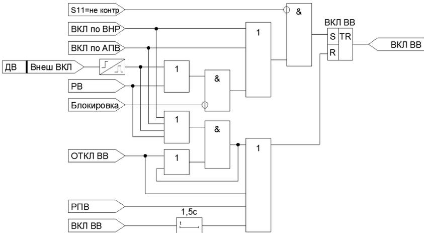
Рисунок 4.3.9 – Функциональная схема формирования сигнала включения ВВ
