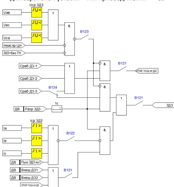
Рисунок 4.1.26 – Функциональная схема ЗД3 для сервисной уставки «Тип присоединения» = ВВ
