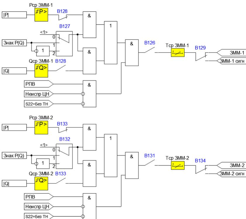
Рисунок 4.1.28 – Функциональная схема ЗММ-1 и ЗММ-2
