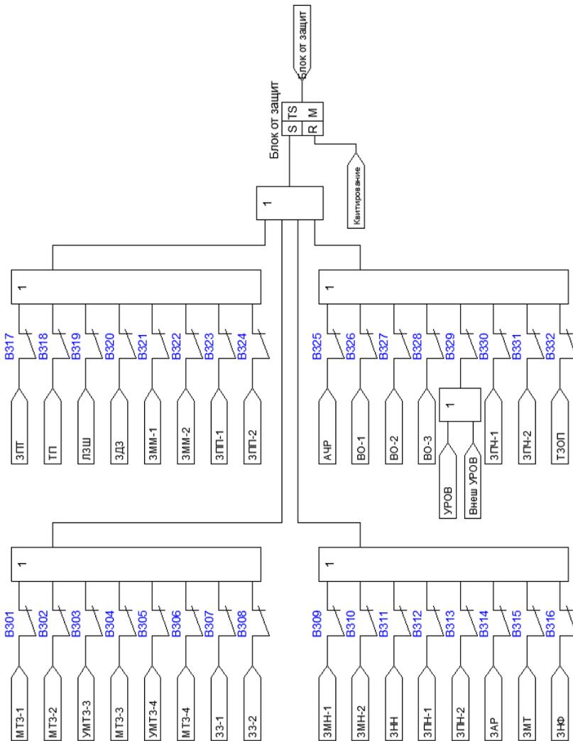
Рисунок 4.3.7 – Функциональная схема формирования сигнала блокировки от защит
