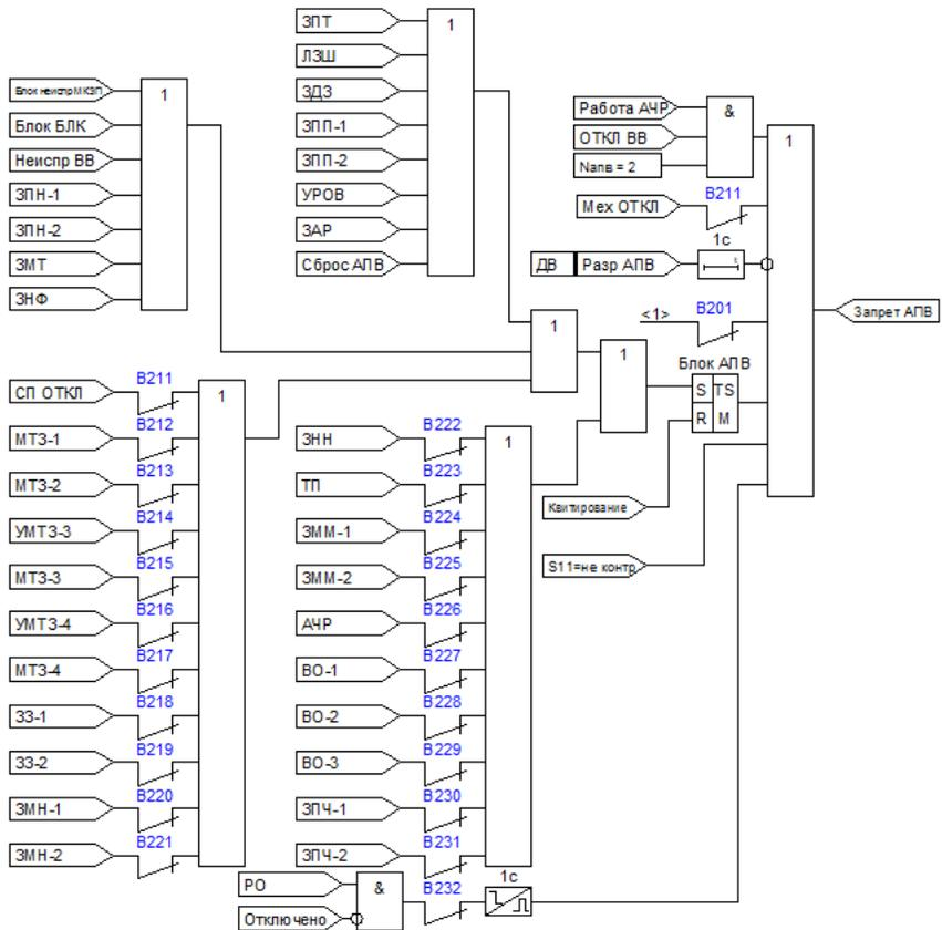
Рисунок 4.2.4 – Функциональная схема формирования сигнала запрета АПВ
