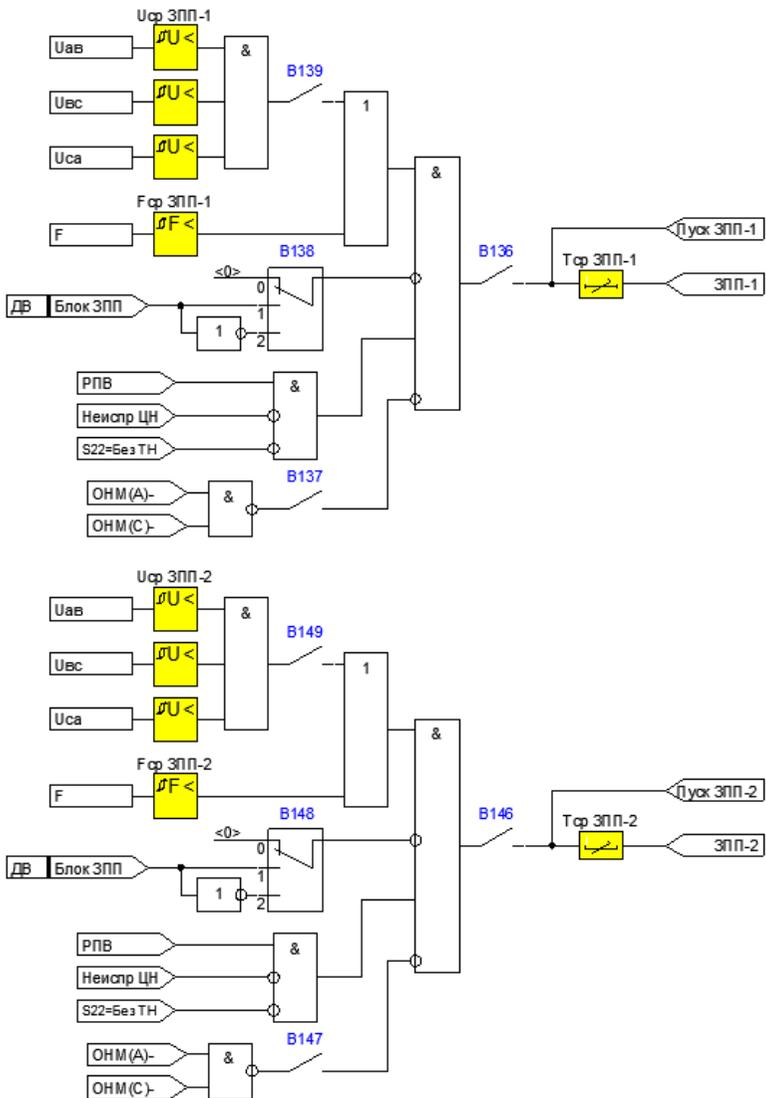
Рисунок 4.1.29 – Функциональная схема ЗПП-1 и ЗПП-2
