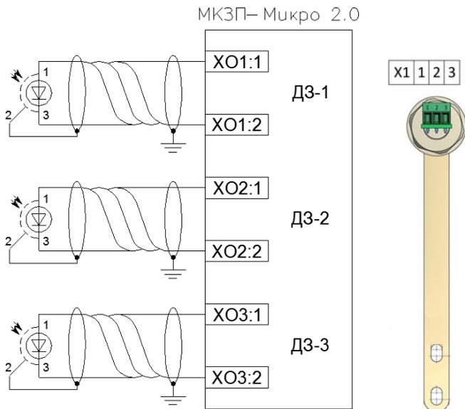
1. Датчики тока дуговой защиты ДДЗ-01 подключаются к блоку защиты экранирующим проводом для слаботочных сигналов. Рекомендуемый провод – КГПЭФВм 1х2х0,78 (входит в комплект поставки).
