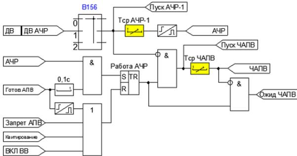
Рисунок 4.2.10 – Функциональная схема АЧР по одному ДВ
