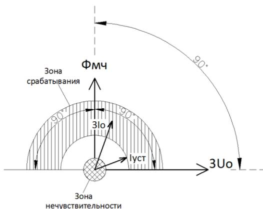
Рисунок 4.1.8 – Определение направления мощности нулевой последовательности
