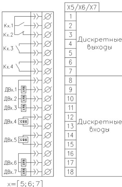
Рисунок 3.1 – Конфигурация разъемов дополнительных дискретных входов и выходов
