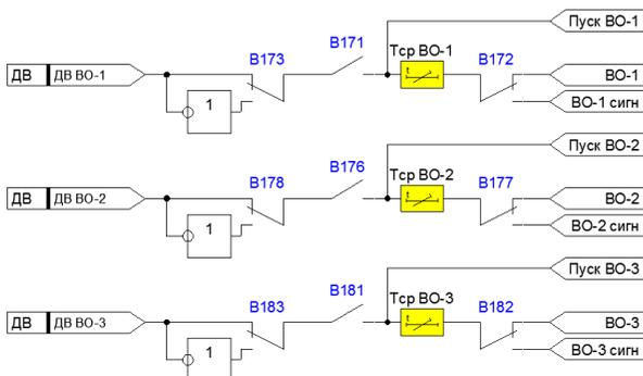
Рисунок 4.2.13 – Функциональная схема внешнего отключения
