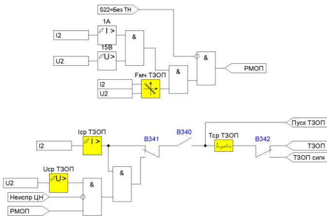
Рисунок 4.1.32 – Функциональная схема ТЗОП
