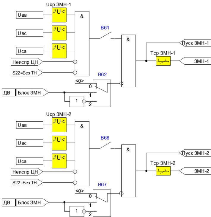
Рисунок 4.1.10 – Функциональная схема ЗМН-1 и ЗМН-2 для сервисной уставки «Тип присоединения» = ТН
