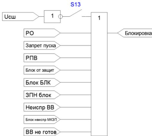
Рисунок 4.3.10 – Функциональная схема формирования сигнала блокировки РВ
