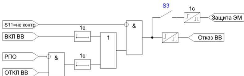
Рисунок 4.4.2 – Функциональная схема формирования сигнала отказа ВВ
