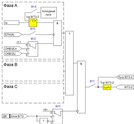
Рисунок 4.1.1 – Функциональная схема МТЗ-1 и МТЗ-2
