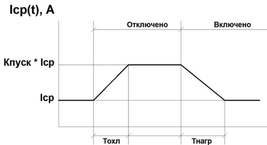
Рисунок 4.1.3 – Функция учета холодного пуска нагрузки
