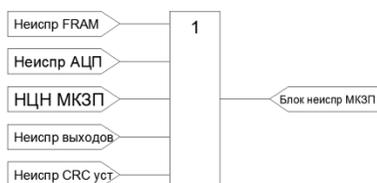
Рисунок 4.15 – Функциональная схема сигналов самодиагностики устройства
