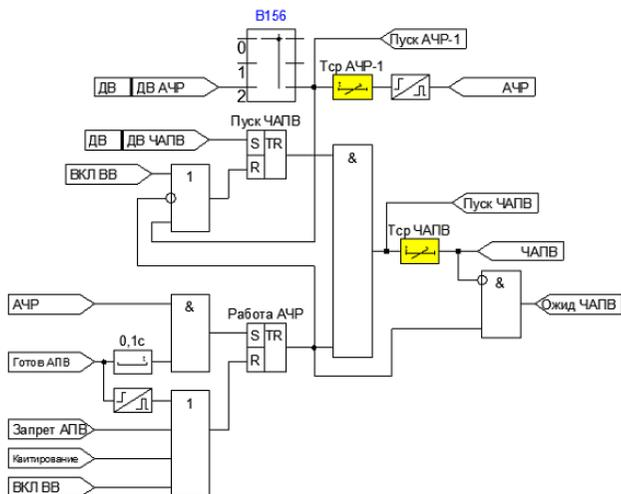
Рисунок 4.2.11 – Функциональная схема АЧР по двум ДВ
