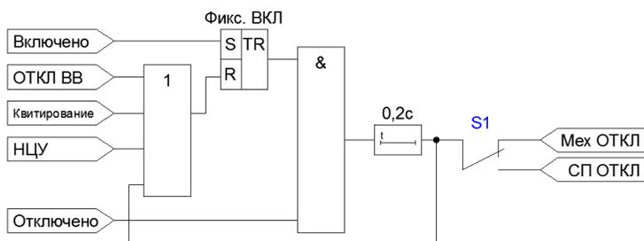
Рисунок 4.4.3 – Функциональная схема формирования сигнала отказа ВВ
