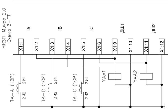
**Подключение датчиков дуговой защиты ДДЗ-01 к МКЗП-Микро 2.0**
