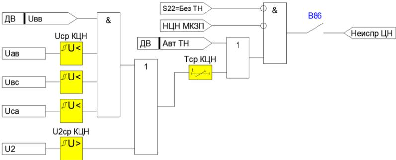
Рисунок 4.1.14 – Функциональная схема контроля ЦН для камеры ТН
