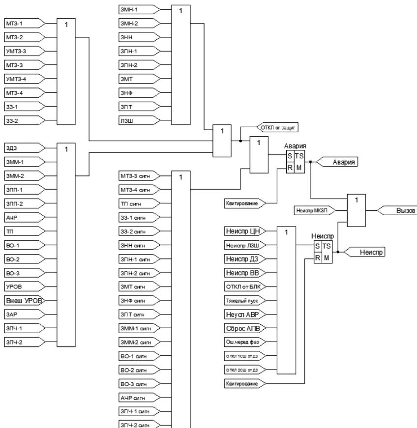
Рисунок 4.5 – Функциональная схема формирования сигналов сигнализации
