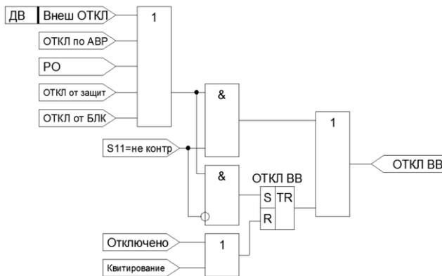
Рисунок 4.3.8 – Функциональная схема формирования сигнала отключения ВВ
