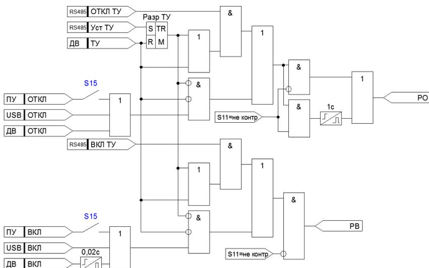
Рисунок 4.3.5 – Функциональная схема ручного управления ВВ при настройке «МУ» как «всегда 0» и настройке «ТУ» на ДВ
