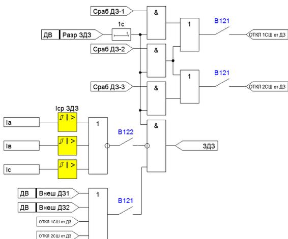
Рисунок 4.1.25 – Функциональная схема ЗД3 для сервисной уставки «Тип присоединения» = СВ
