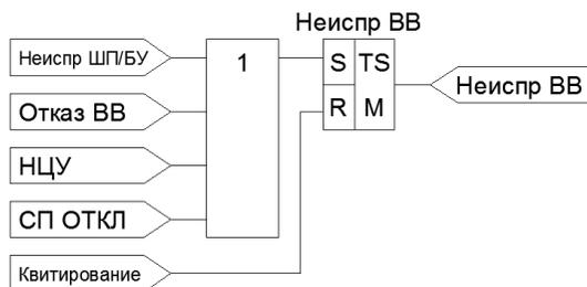
Рисунок 4.4.4 – Функциональная схема формирования сигнала неисправности ВВ
