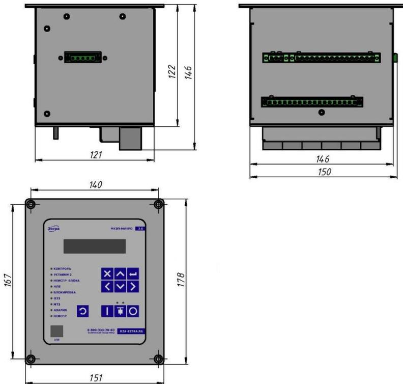
Габаритный чертёж корпуса в модификациях: 2.0-2-Т, 2.0-2-ДШ,
