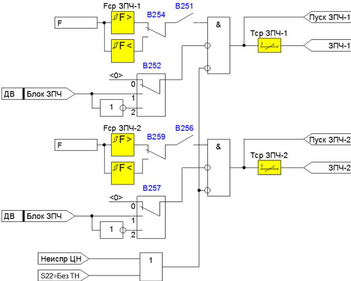
Рисунок 4.1.31 – Функциональная схема ЗПЧ для сервисной установки «Тип присоединения» = ТН
