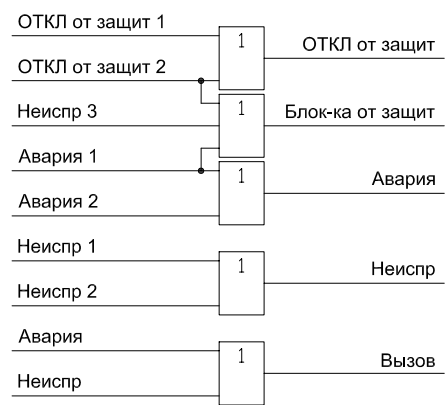
Рисунок 1.6.24 – Функциональная схема формирования сигналов управления выходными и сигнальными реле
