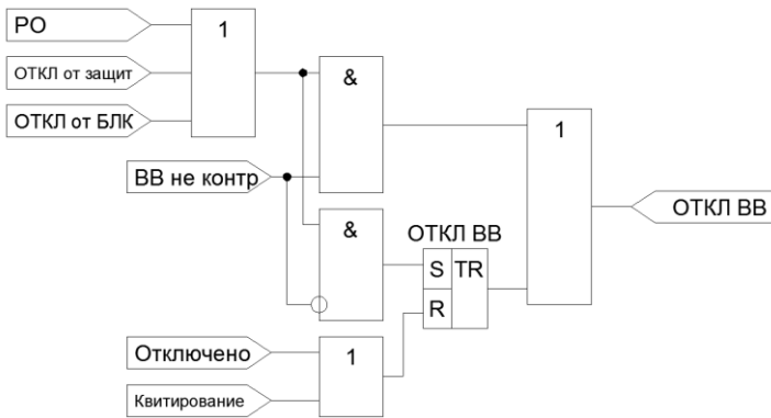
Рисунок 4.3.6 – Функциональная схема формирования сигнала отключения ВВ
