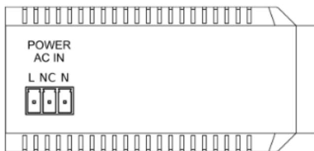
Рис.4. Внешний вид ЭСТРА-МОДЕМ. Сторона разъема питания.
