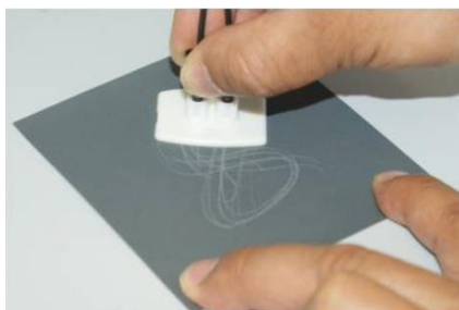
Рисунок 5.5 - Процесс шлифования торца оптоволоконна
