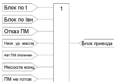
Рисунок 4.5.5 – Функциональная схема формирования сигнала блокировки привода РПН
