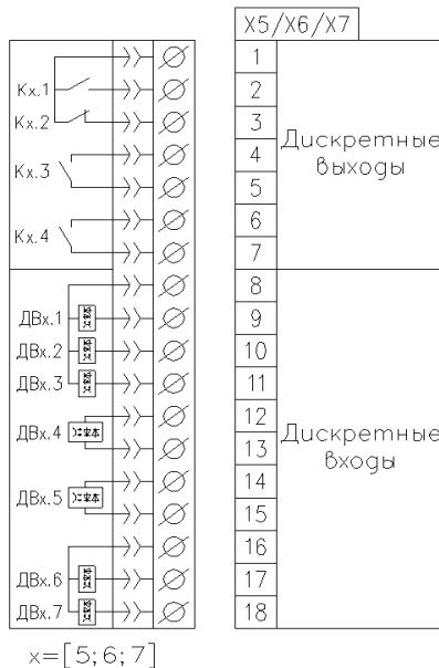
Рисунок 3.1 – Конфигурация разъемов дополнительных дискретных входов и выходов
