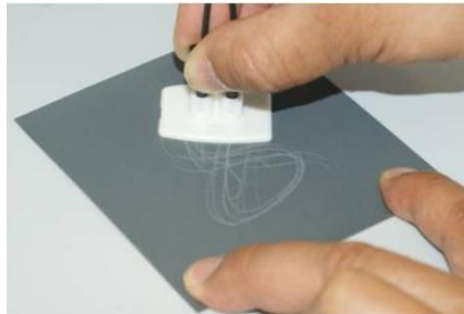
Рисунок 5.5 - Процесс шлифования торца оптоволоконна
