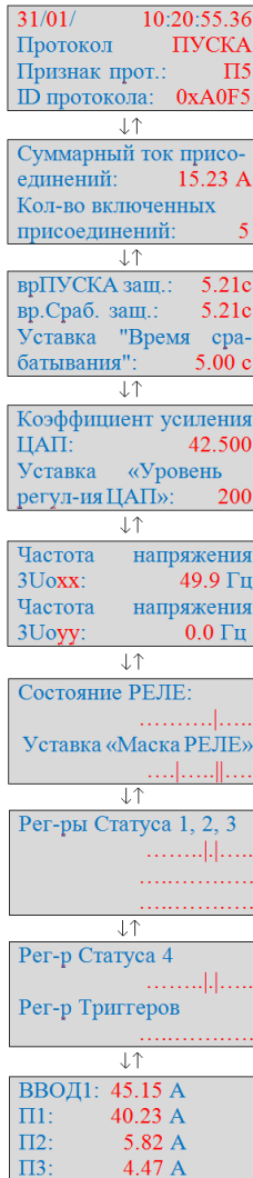
Рисунок 4.3 – Структура меню протокола пуска/срабатывания
